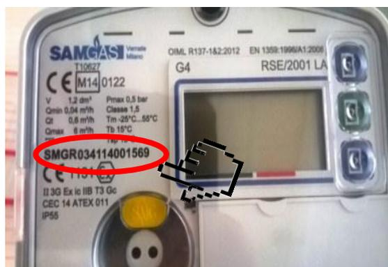
La matricola (seriale) del contatore è presente sul quadrante protetto e corrisponde ai primi 11 numeri a partire da destra (Ad esempio nel caso della foto riportata a fianco la matricola del contatore è **34114001569**).
