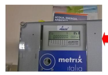
Il contatore elettronico è dotato di display a cristalli liquidi sempre acceso con visualizzazione e rotazione ciclica dei dati.
