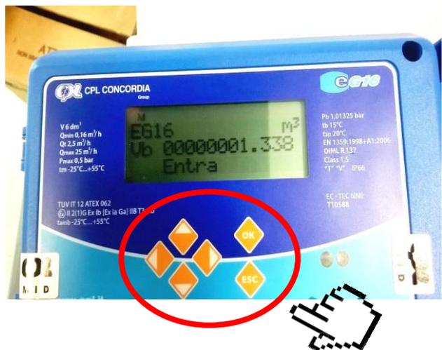
Il contatore elettronico è dotato di display a cristalli liquidi, il display del dispositivo è normalmente spento.
