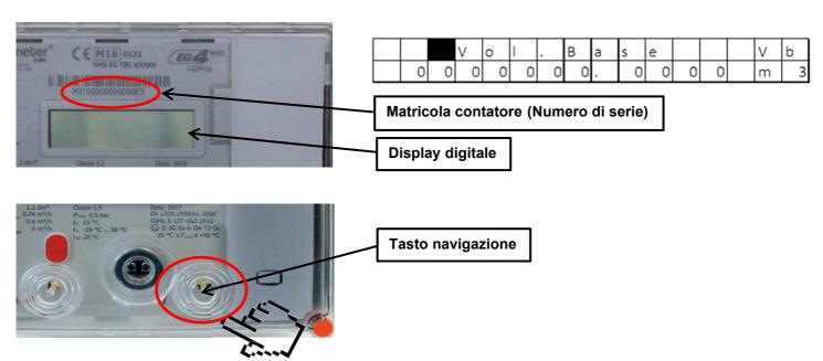
Il contatore elettronico, riporta sul fronte (appena sopra il display) la matricola contatore (Numero di serie).
