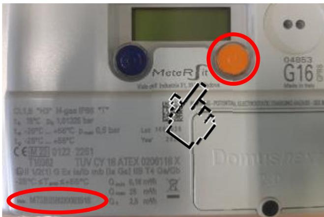
La matricola (seriale) del contatore è rilevabile direttamente sul contatore in basso a sinistra (vedi foto a fianco).
