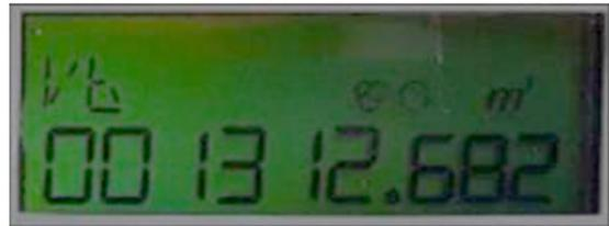
La lettura del contatore è rilevabile sul display, simbolo **Vb (Volume di base)**, premendo una volta il tasto arancione posto sul contatore (nell'esempio sopra riportato la lettura di **1312 mc**). Le cifre da considerare per rilevare la lettura sono quelle poste a sinistra del punto poiché quelle a destra sono i decimali.
