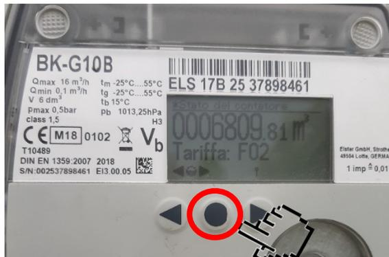
Il contatore elettronico è dotato di display a cristalli liquidi, il display del dispositivo è normalmente spento per ragioni di risparmio energetico.
