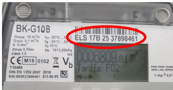
La **matricola** (seriale) del contatore è rilevabile direttamente sulla parte frontale del contatore sotto il codice a barre (vedi foto a fianco).
