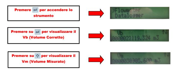
**Attenzione:** dopo qualche minuto il display dello strumento si spegne automaticamente se non più interrogato.
